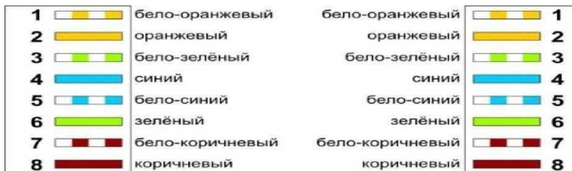
Рис. 3. Схемы обжимки кабеля: а - прямой кабель
