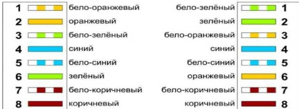
Рис. 4. Схемы обжимки кабеля: б - перекрёстный (кроссовер)
