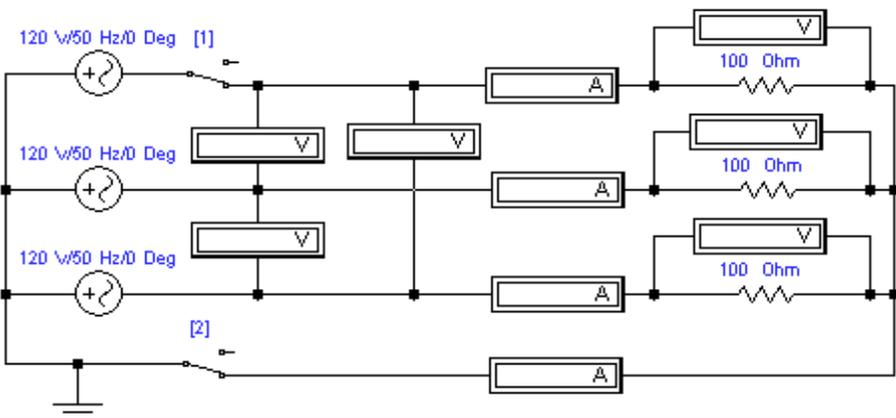
4. При равномерной нагрузке снимите показания приборов с нулевым проводом и без него (для отключения нулевого провода разомкните ключ 2). Показания приборов занесите в таблицу 1.
