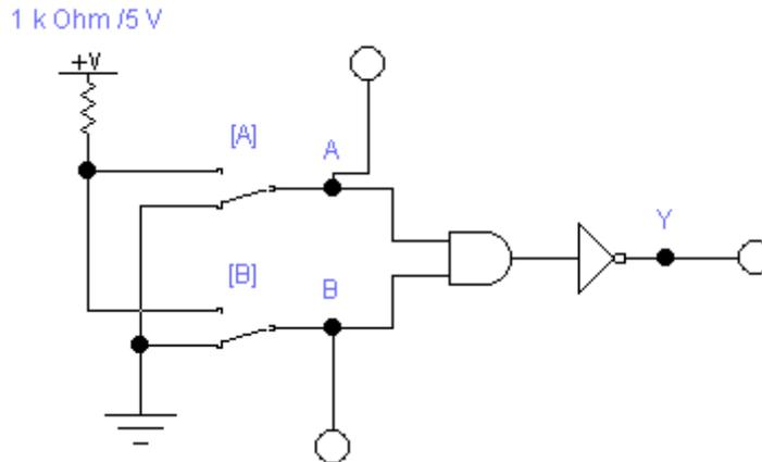
5. Включите схему. Подайте на входы схемы все возможные комбинации уровней входных сигналов и, наблюдая уровни сигналов на входах и выходе с помощью логических пробников, заполните таблицу истинности 2 логической схемы 2И-НЕ.
