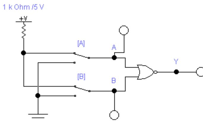
15. Подайте на входы системы все возможные комбинации уровней входных сигналов и, наблюдая уровни сигналов на входах и выходе с помощью логических пробников, заполните таблицу истинности 6 логической схемы 2ИЛИ-НЕ.
