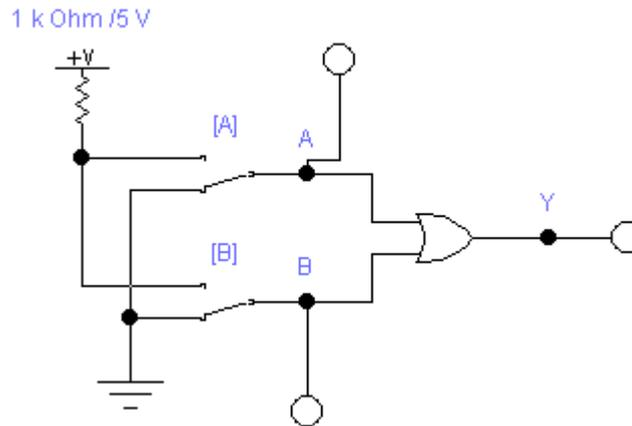
10. Включите схему. Подайте на входы схемы все возможные комбинации уровней входных сигналов и, наблюдая уровни сигналов на входах и выходе с помощью логических пробников, заполните таблицу истинности 4 логической схемы ИЛИ.
