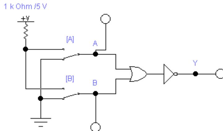
13. Включите схему. Подайте на входы схемы все возможные комбинации уровней входных сигналов и, наблюдая уровни сигналов на входах и выходе с помощью логических пробников, заполните таблицу истинности 5 логической схемы 2ИЛИ-НЕ.
