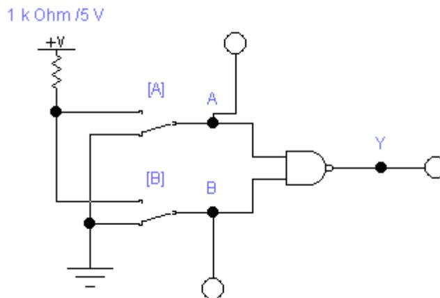
7. Включите схему. Подайте на входы схемы все возможные комбинации уровней входных сигналов и, наблюдая уровни сигналов на входах и выходе с помощью логических пробников, заполните таблицу истинности 3 логической схемы 2И-НЕ.
