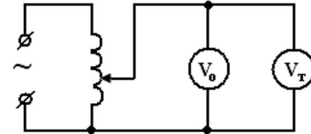
5. Изменяя положение подвижного контакта реостата, выполните пять замеров величины напряжения технического и образцового вольтметров. Запишите показания приборов в таблицу 2.
