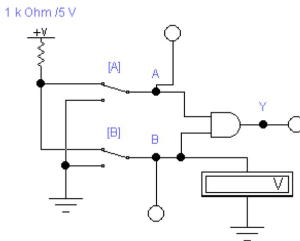
В этой схеме два двухпозиционных переключателя А и В подают на входы логической схемы И уровни 0 (контакт переключателя в нижнем положении) или 1 (контакт переключателя в верхнем положении).
